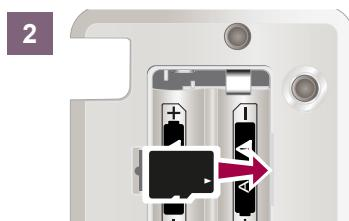
Para expulsar la tarjeta Micro SD, empújela hacia dentro en la ranura y suelte. Saque la tarjeta de la ranura.
