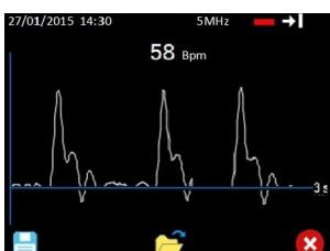
Stiskem tlačítka uložíte ***viditelnou část*** průběhové křivky do trvalé paměti.
