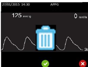
Stiskem tlačítka obrazovku ukončíte a přejdete na úvodní obrazovku APPG bez uložení.
