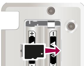
Mikro SD kartu uvolnите zatlačením hlouběji do otvoru pro kartu, čímž se vysune.
