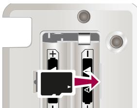
Zur Entnahme der Micro-SD-Karte schieben Sie diese ein Stück weiter in den Kartenslot, damit sie ausgeworfen wird. Ziehen Sie die Karte aus dem Slot.
