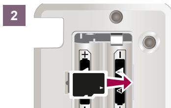
For å utløse Micro SD-kortet trykk det videre inn i kortsporet slik at det skyves ut. Trekk kortet ut av sporet.
