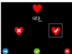
Drücken Sie , um die Markierung zwischen der Anzeige der Herzfrequenz und der Unterdrückung der Anzeige hin- und herzubewegen.
