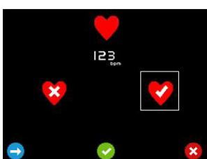
Tryck på för att flytta markören mellan visning av hjärtfrekvens och ingen visning av hjärtfrekvens .
