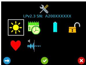
Když je připojena vaskulární sonda, obrazovka nabízí přístup k obrazovce výběru zobrazení srdeční frekvence a obrazovce potlačení syčení u systému DDNR.
