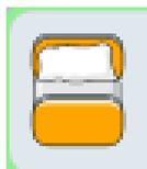
Das System kann so konfiguriert werden, dass die Patientin nach Ausschalten eines CTG automatisch entlassen wird. Nach dem Ausschalten des CTG erscheint das Bett orangefarben, bis die Patienten entlassen wird.
