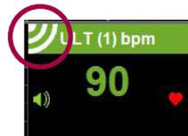
Zur Deaktivierung des Funkbetriebs und Rückkehr zur verkabelten Überwachung, koppeln Sie die Funksonde wieder an die Ladeschale des Empfängers.
