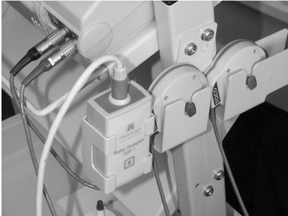
Gráfico 2 - Imagen aumentada que muestra el módulo de la PIU instalado en un carrito.
