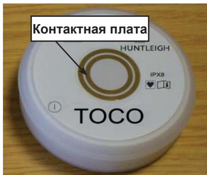
На верхней панели датчика находится контактная плата. Когда датчик подключается к станции для зарядки, два контактных кольца должны быть совмещены с зарядными контактами на приемнике. Все кольца размыкаются внутри во время эксплуатации.
