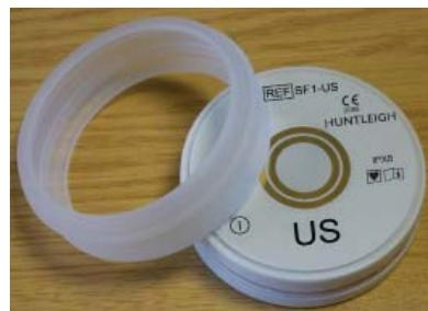
Датчики защищаются от повреждений с помощью силиконового покрытия. Никогда не используйте датчик без этого защитного покрытия. При необходимости его можно снять для чистки. См. инструкции в Разделе 6.2.
