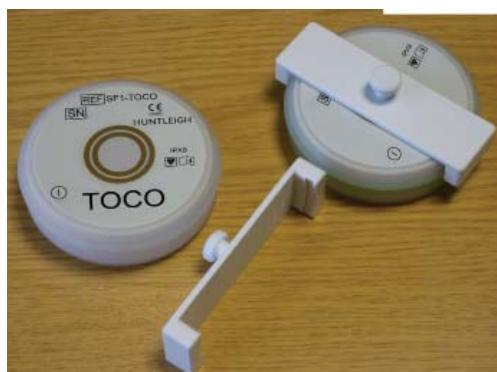
Датчики размещаются с использованием ременных зажимов, которые входят в комплект поставки (это такие же зажимы, которые используются для проводных датчиков FM800Encore).
