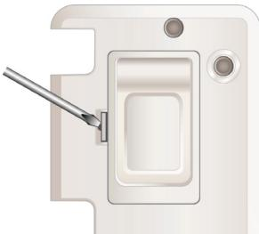
Insira uma ferramenta adequada na reentrância para soltar o clipe e levante cuidadosamente a tampa das pilhas.
